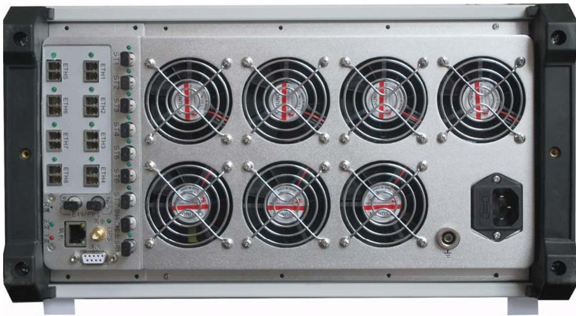
1. 背面风扇的用途为：给电流放大器和电压放大器散热，当放大器为输出状态时风扇转速会增加，风扇的声音也会随之增加。
