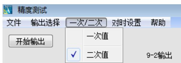
对时设置：可选择手动输出、同步输出，后者又包括本机作为主时钟和本机作为从时钟两种方式。手动输出，无对时要求，点击“开始输出”后，直接就输出。本机作为主时钟，测试仪作为主时钟给被测设备对时，同时测试仪按照自身时钟在下一整秒开始输出。本机作为从时钟，外部时钟装置给测试仪与被测设备分别对时，同时测试仪按照外部时钟信号在下一整秒开始输出。
