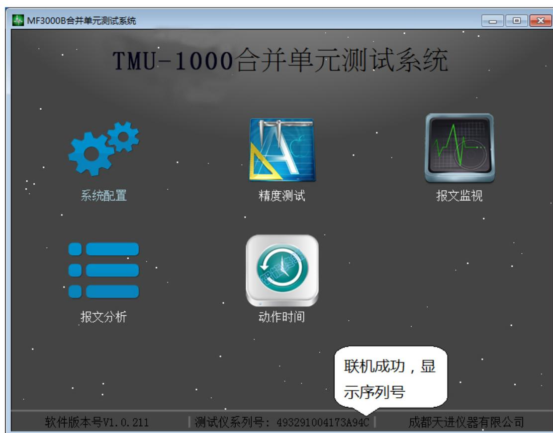
如果系统通信不正常，则测试仪序列号处显示未联机，此时可以关闭主界面，重新启动尝试联机，如下：
